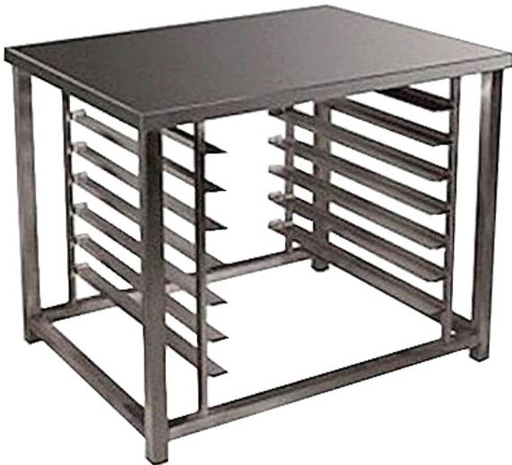
Подставка Assum ППК-9/9 предназначена для размещения пароконвектоматов на предприятиях общественного питания и торговли. Модель оснащена обвязкой с 4 сторон и регулируемыи по высоте пластиковыми опорами. Каркас выполнен из трубы 40x40 мм нержавеющей стали AISI 430, вертикальные опоры направляющих - из квадратной трубы 20x20 мм нержавеющей стали AISI 430, столешница, направляющие и обвязка - из нержавеющей стали AISI 430.
