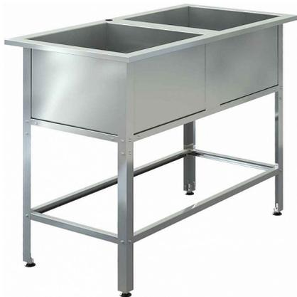
Моечная ванна Assum ВМС-С-2/530 серии Стандарт предназначена для мытья кухонного инвентаря на предприятиях общественного питания. Модель оснащена 2 сварными раковинами, отверстием под смеситель и выпуском. Раковины выполнены из нержавеющей стали AISI 201, каркас – из углового профиля из оцинкованной стали, обвязка с 4 сторон – из профиля из оцинкованной стали, подпятники опор – из прочного пластика.
