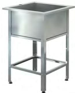
Моечная ванна Assum ВМС-С-1/430 серии Стандарт предназначена для мытья кухонного инвентаря на предприятиях общественного питания. Модель оснащена 1 раковиной, отверстием под смеситель и выпуском. Сварная раковина выполнена из высококачественной нержавеющей стали AISI 430, каркас – из углового профиля из оцинкованной стали, обвязка с 4 сторон – из профиля из оцинкованной стали, подпятники опор – из прочного пластика.
