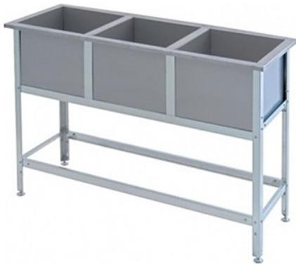
Моечная ванна Assum ВМС-С-3/400 серии Стандарт предназначена для мытья кухонного инвентаря на предприятиях общественного питания. Модель оснащена 3 раковинами, отверстием под смеситель и выпуском. Сварные раковины выполнены из высококачественной нержавеющей стали AISI 430, каркас – из углового профиля из оцинкованной стали, обвязка с 4 сторон – из профиля из оцинкованной стали, подпятники опор – из прочного пластика.
