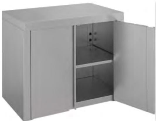
Полка настенная (навесная) сварная закрытая, серии Премиум, с 2 распашными дверями, сплошной промежуточной полкой, полкой-дномом изготовлена из нержавеющей стали 430 толщиной 1мм ( боковые стенки) и 0,7мм (каркас, двери, полки, усиления полок). Полка предназначена для длительного хранения посуды и инвентаря в закрытом пространстве на профессиональной кухне предприятий общепита.
