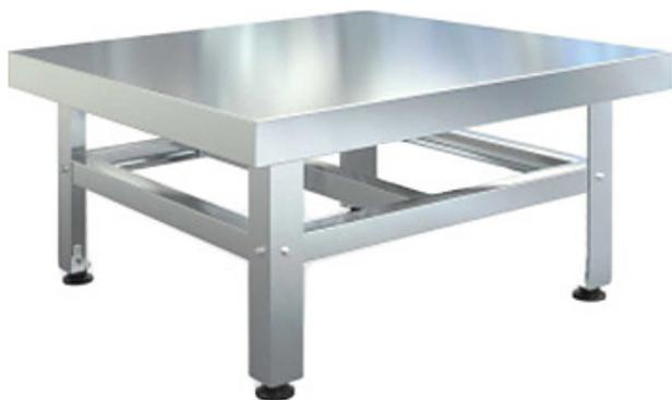
Подставка Assum ПП-П-15/4 серии Премиум предназначена для временного размещения различного оборудования, кухонного инвентаря и прочих предметов на предприятиях общественного питания и торговли. Модель оснащена обвязка с 4-х сторон и регулируемыми по высоте опорами. Разборный каркас выполнен из уголка 40x40 мм из нержавеющей стали AISI 430, столешница - из нержавеющей стали AISI 430 с усилением из ламинированной древесно-стружечной плиты (ЛДСП), рамка столешницы - из оцинкованной стали.
